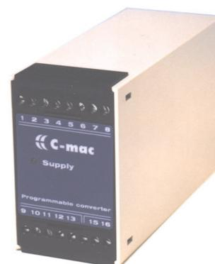
Le PCV 10 est un convertisseur de mesure programmable à entrée courant, tension et fréquence, et à sortie courant, tension, ou impulsions. Le boîtier possède 3 entrées courant et 3 entrées tension, ce qui permet de programmer toute étendue de mesure de 20  $\mu$ A à 10 A ou de 10 mV à 1000 VCA/1500 VCC.
